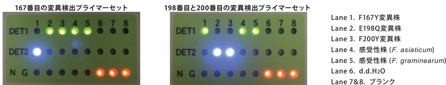
図2 LF-8 本体の自動判定機能によるLED点灯パターン
