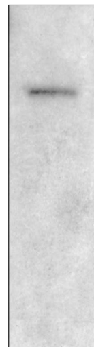
図5 マウス細胞の DNA 5 \mu g を EcoR I で消化後、0.7% Agarose S で電気泳動を行い、ニトロセルロースメンブランにブロットングし、 32 P 標識した cDNA をプローブとして、ハイブリダイゼーションを行った。オトラジオグラフィーは 4°C で一晩行った。
