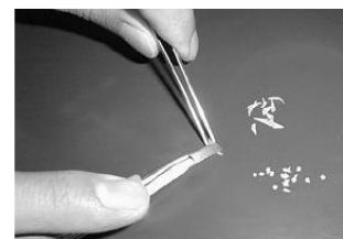
爪切りで切った爪をカッターで 1 mm 角に切っているところ
